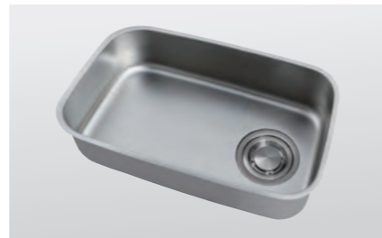
品番：SSB75BO-01 材質：SUS304 サイズ：W750×D400×深さ190
